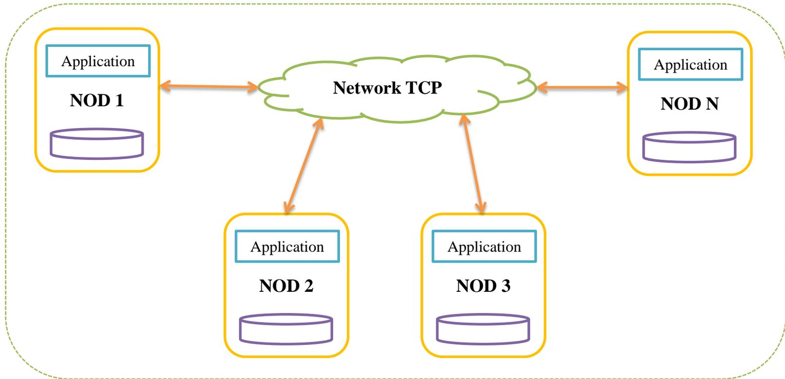
Ключевой особенностью СХД на базе распределенной файловой системы, например, Сeph, является объединение отдельных узлов (NOD-ов), в единое кластерное хранилище данных. СХД такой модели отличаются высокой емкостью и отказоустойчивостью, имеют возможность гибкой масштабируемости. При этом в качестве блочных устройств хранения могут использоваться как отдельные диски в каждом NOD, либо уже созданные хранилища данных.
