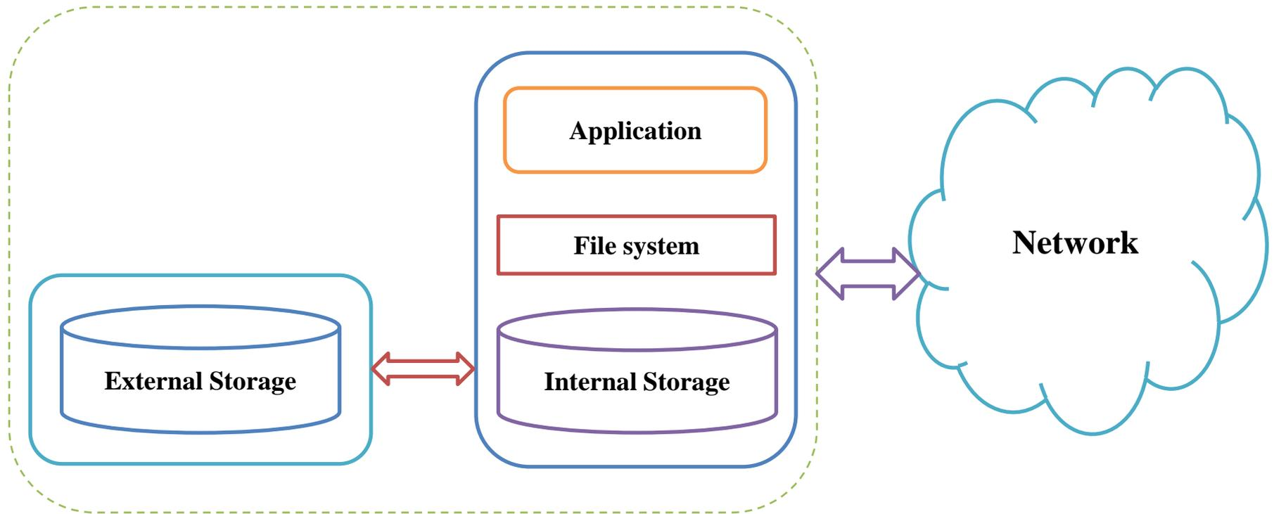
Ключевой особенностью подключения блочных устройств в СХД модели DAS/SAS является непосредственное подключение к внутренним или внешним портам соответствующих интерфейсов с использованием необходимых кабелей. В этой модели все необходимое ПО для работы СХД устанавливается непосредственно на сервер, а блочные устройства форматируются в соответствии с требованиями к файловой системы.
